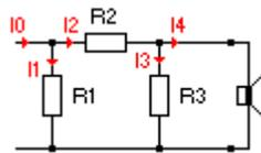
$$I_2 = I_0 \cdot \frac{R_1}{R_1 + R_2 + \frac{R_3 \cdot Z_C}{R_3 + Z_C}}$$
