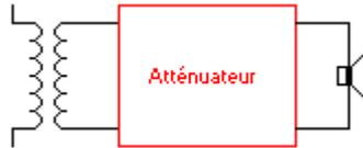
Sur le schéma ci-dessus le transfo de sortie, l'atténuateur et le haut-parleur. Pour qu'un atténuateur ne perturbe ni le transformateur de sortie ni le HP, il doit être « transparent ».
