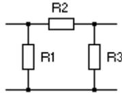
Pour une atténuation de -6dB avec un HP de  $8\Omega$ , on obtient par le calcul :
